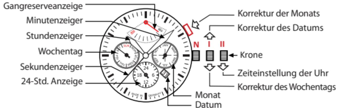
**DATUMSEINSTELLUNG:** Krone bis zum 1. Einrastpunkt herausziehen und durch Drehen der Krone im Uhrzeigersinn das Datum einstellen, dann die Krone wieder in die Nullstellung [ N ] drücken.
